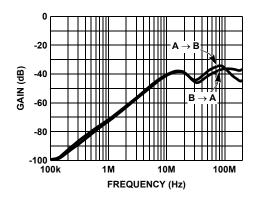
FIGURE 30. CHANNEL-TO-CHANNEL ISOLATION vs FREQUENCY
