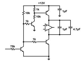
FIGURE 39. IMPLEMENTATION OF ENABLE/DISABLE FUNCTION
