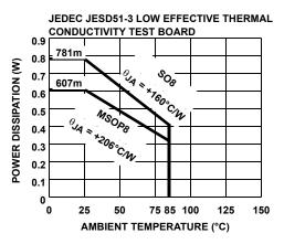
FIGURE 37. PACKAGE POWER DISSIPATION vs AMBIENT TEMPERATURE
